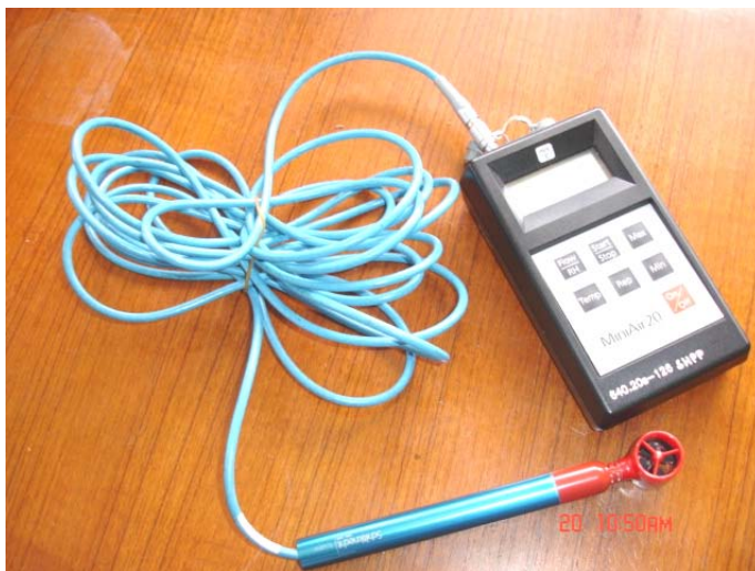
Photo A5-3: Mini Air current meter
